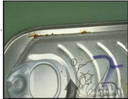
Ligne d'amincissement endommagée
